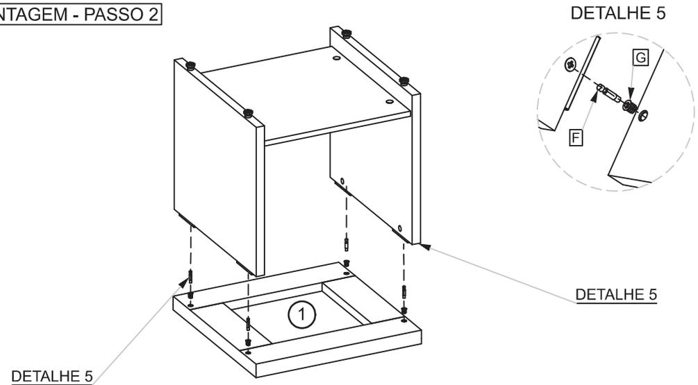
NA SEQUENCIA PARA FACILITAR A FIXAÇÃO DO TAMPO (1) NA ESTRUTURA, POSICIONE O TAMPO (1) NO CHÃO E FAÇA A FIXAÇÃO TOTAL DOS PÉS LATERAIS COM CONFORME DETALHE 5.
