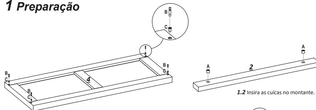
**1.1** Com o auxílio de uma chave allen nº6, fixe as buchas americanas. Em seguida parafuse os pinos minifix com o auxílio da chave philips.
