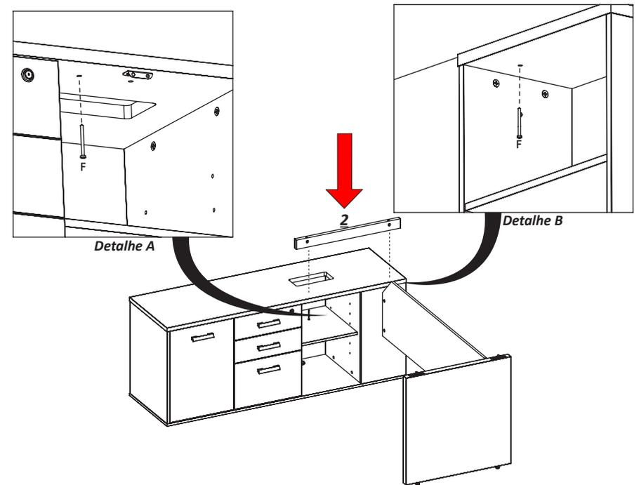
2.3 Faça a fixação do montante no tampo do armário. Na face inferior do tampo existem marcações para fixar o parafuso, conforme Detalhe A e B.
