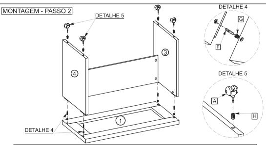
NA SEQUENCIA PARA FACILITAR A FIXAÇÃO DO TAMPO (1) E DOS RODIZIOS NA ESTRUTURA, POSICIONE O TAMPO (1) NO CHÃO E FAÇA A FIXAÇÃO TOTAL DOS PÉS LATERAIS COM CONFORME DETALHE 4 ÉM SEGUIDA INSIRA A BUCHA PLASTICA NO PÉ PAINEL (3,4) E FIXE O RODIZIO CONFORME DETALHE 5.
